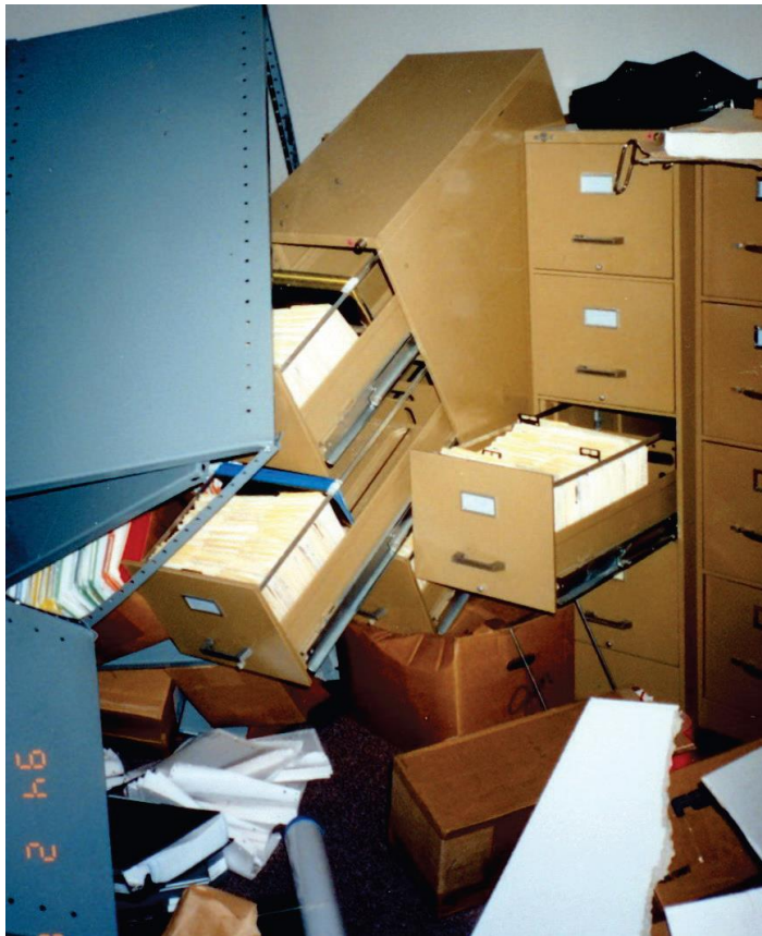
איור 6.5.5.1-1 – נפילת ארון תיוק עקב רעידת אדמה.
